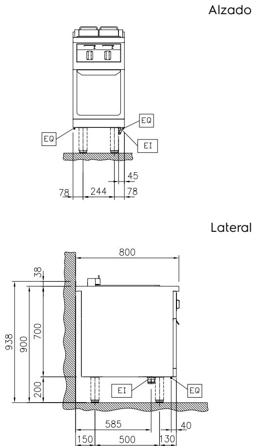
El = Conexión eléctrica (energía)
